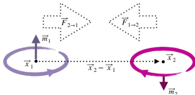
*Entgegen orientierte Dipole in einer Ebene ziehen einander an. Gleichzeitige Dipole stoßen einander ab. Die Kraft fällt wie  $1/d^4$  ab.*
